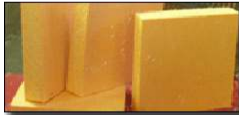
образец экструдированного пенополистирола
