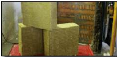
образец минераловатной плиты
