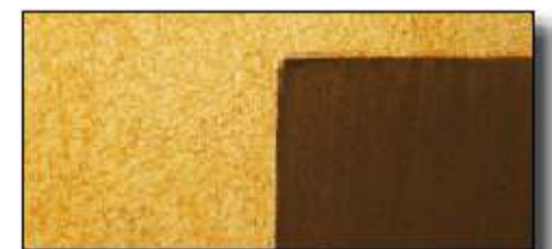
Внешний вид фрагмента фасадной системы с теплоизоляцией из пеностекла после 700 циклов воздействия перед демонтажем.
