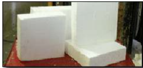
образец блочного пенополистирола (ПСБ-С 25)
